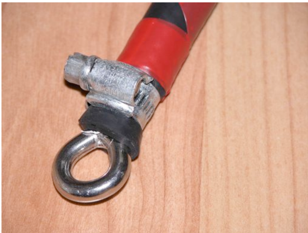
8. Particolare del fissaggio dell'anello al tubo
