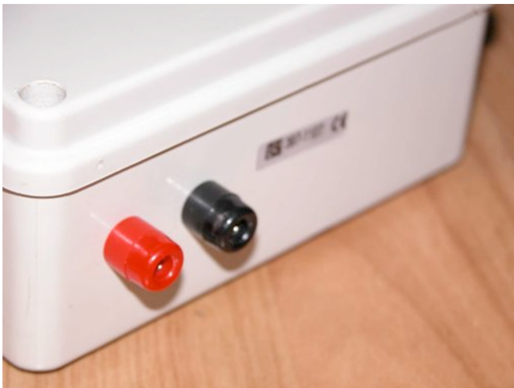
4. Particolare delle prese a "banana" sulla scatola
