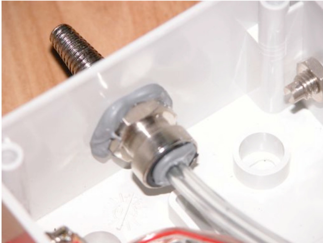
7. Particolare del fissaggio del tubetto "crystal" al raccordo aria
