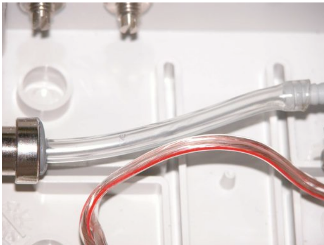
6. Particolare del tubetto "crystal". Notare il forellino applicato con uno spillo rovente allo scopo di rendere "autocompensante" il pressostato in pressione al variare della temperatura
