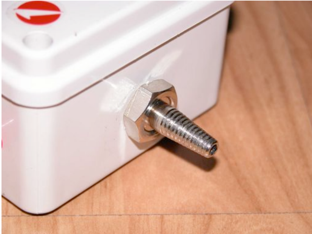
3. Particolare del raccordo aria sulla scatola
